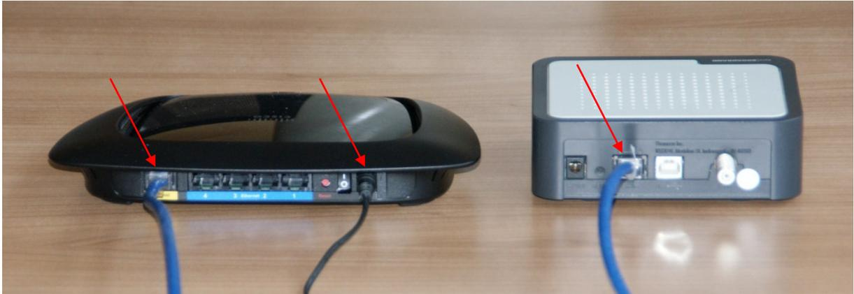
Anschließend ist es für die Konfiguration nötig, dass Sie den Router (Schwarz) mit dem PC verbinden. Dazu nehmen Sie einfach ein LAN-Kabel und schließen es an den PC sowie an einen der 4 freien Ports des Routers an.
